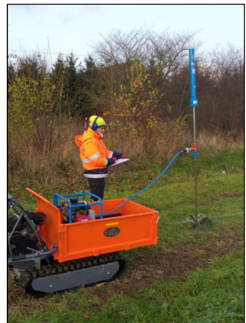
Abb. 4: Durchführung der Rammsondierung (DPL)
