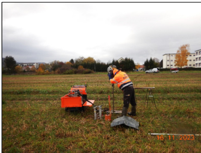
Abb. 2 & 3: Durchführung der Kleinrammbohrungen
