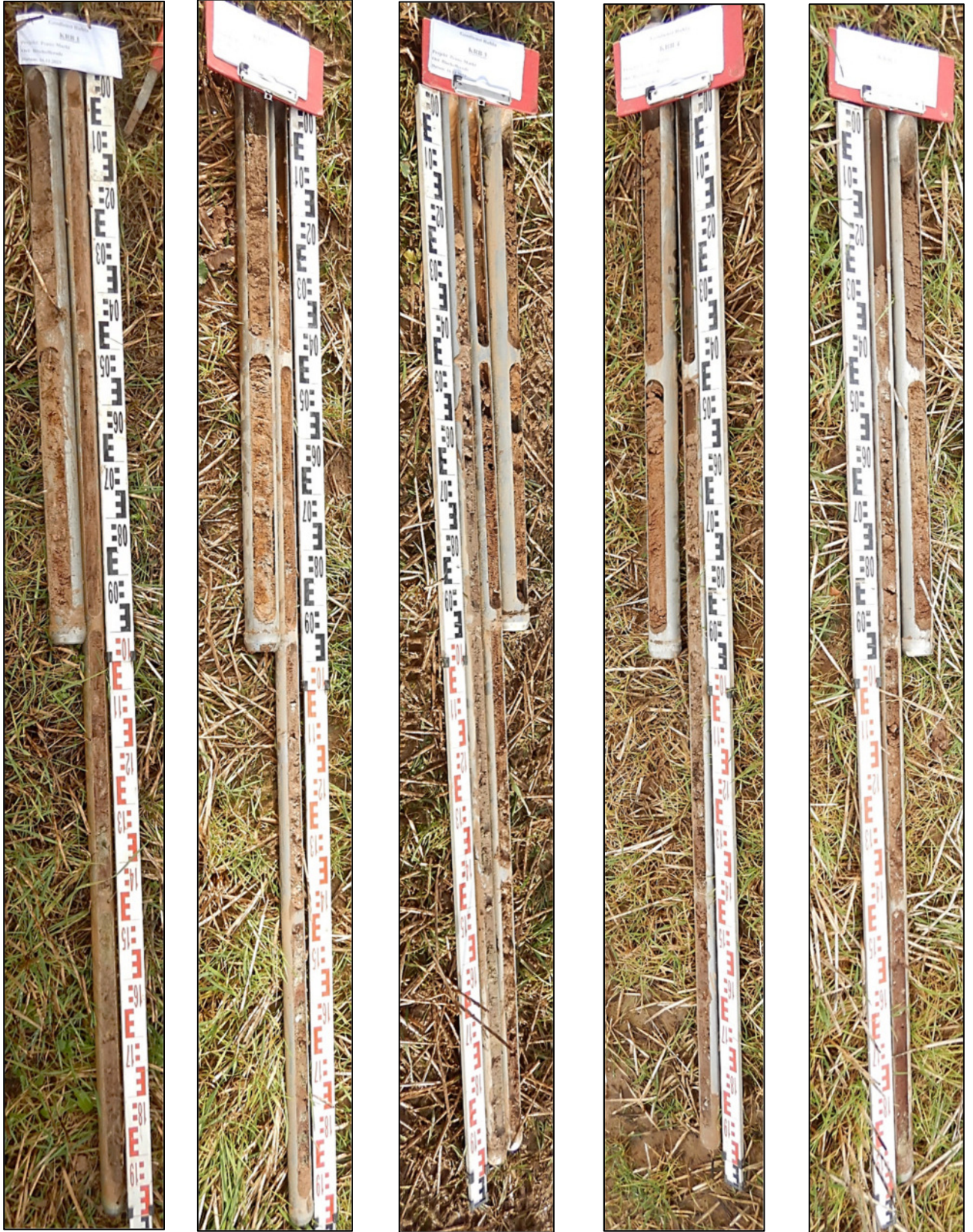
Abb. 5-9: Aufschlussresultate der Kleinrammbohrung KRB 1, KRB 2, KRB 3, KRB 4 und KRB 5 (von links nach rechts)
