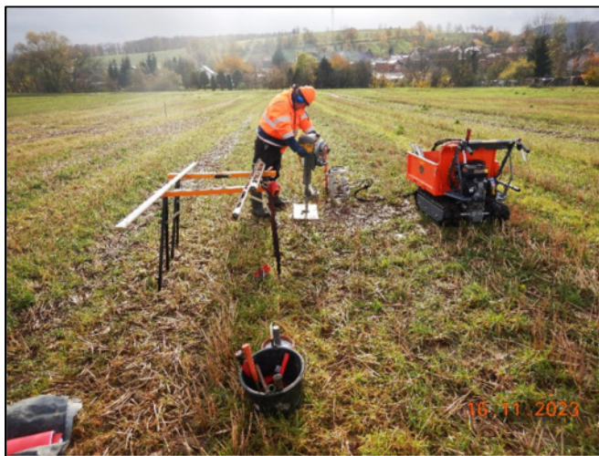
Abb. 2 & 3: Durchführung der Kleinrammbohrungen
